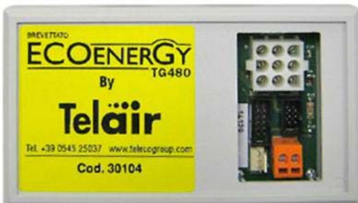
Elektronische besturingseenheid (toegerust voor de afstandsmodule) met besturingsprogramma
